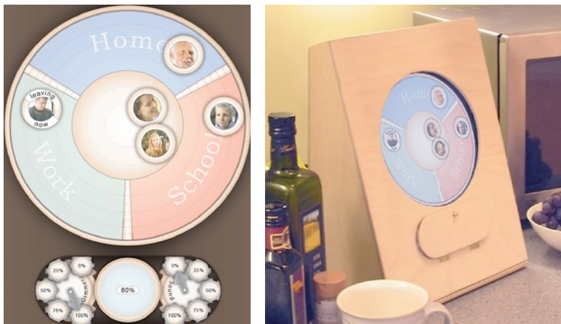
Figura 48: The Whereabouts clock , na versão para o ambiente doméstico. O projeto procura facilitar a identificação do paradeiro de membros de uma família ou de colegas de trabalho, e possibilitar a comunicação entre eles de maneira pouco intrusiva.
