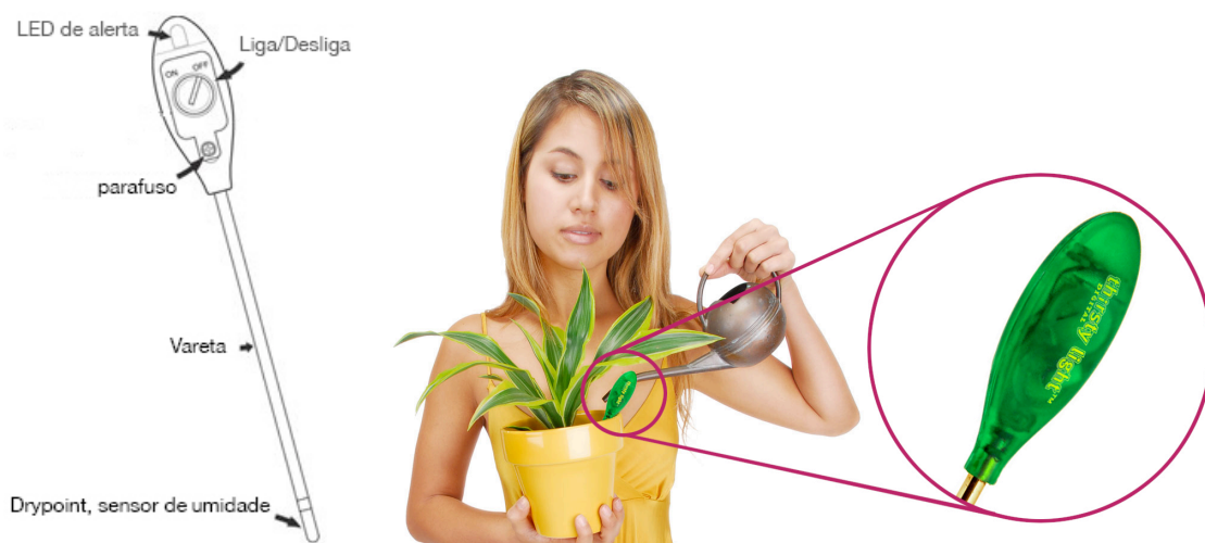
Figura 46: Thirsty Light, aparelho projetado para monitorar a umidade da terra e alertar quando for necessário regar as plantas. (fonte: http://www.thirstylight.com )
