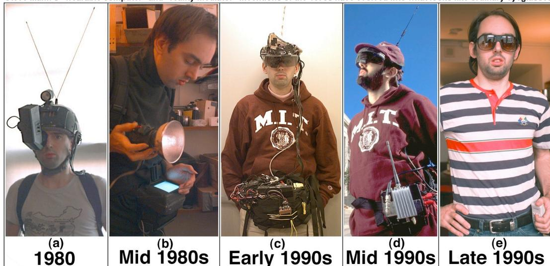
**Figura 7:** A evolução do computador vestível de Steve Mann, desde os anos 80 até a década de 90. De um aparato externamente visível a óculos discretos, uma integração da roupa com sistemas computadorizados. (fonte: [http:// www.wearcam.org](http://www.wearcam.org))
