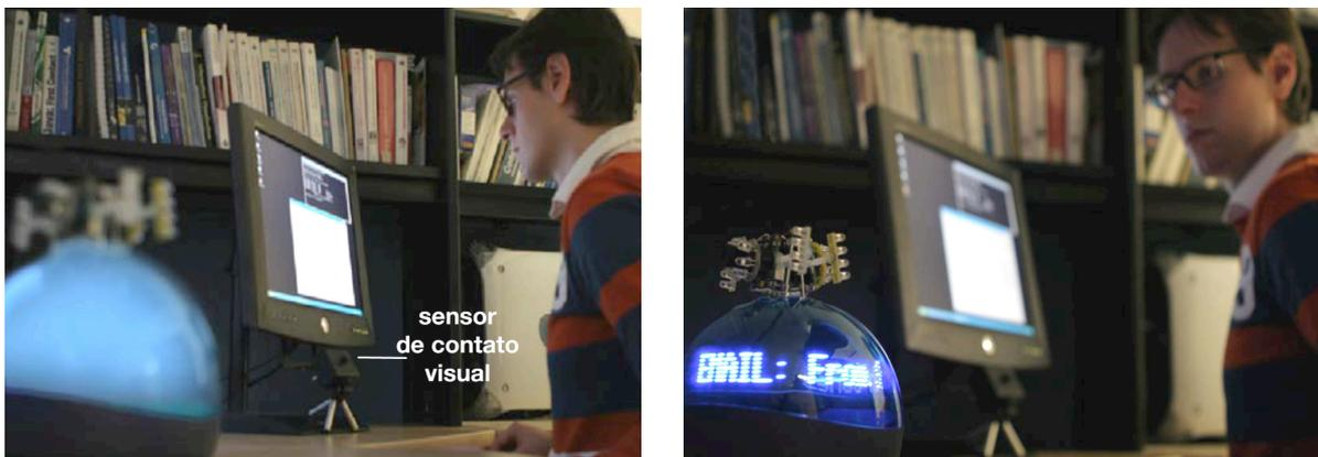
**Figura 25:** *Aura Orb*: o globo ilumina-se quando novos emails chegam na caixa postal. Ao perceber o olhar do usuário em sua direção, o globo exibe a quantidade de mensagens recebidas e/ou o cabeçalho da mensagem (título e remetente).
